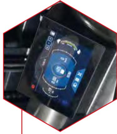
Es gibt ein 7" Touch-Panel für den Bediener, um die Informationen über den Gabelstapler leicht zu sehen und schnell zu intervenieren. Die Geschwindigkeit, der Batteriestand, die Restlebensdauer, **das Gewicht an der Gabel**, die **Höhe der Gabel** Es bietet die Möglichkeit, die Hauptseite ohne Störung der Informationen zu sehen. Die benutzerfreundliche Oberfläche und die Themen bieten eine einfache Bedienung
