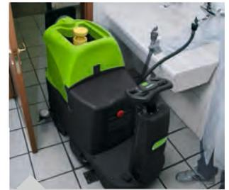
Frischwassertank mit Schlauch für Schnellbefüllung
