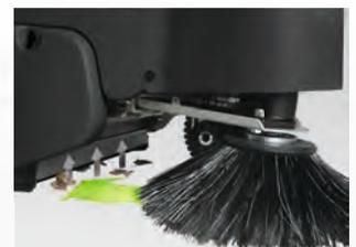
Seitenbürste rechts mit elektrischer Staubabsaugung
