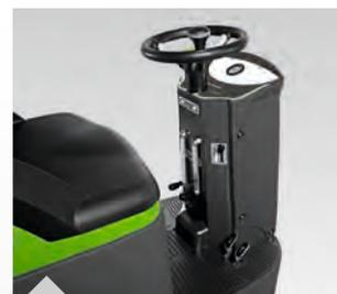
Mechanische Bedienung der Bürsten und Absaugleiste über Hebel
