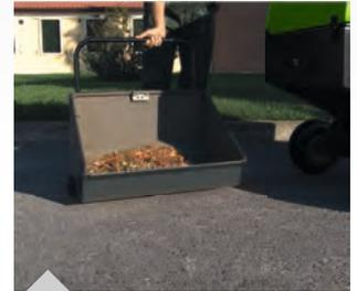
Manuelle Entleerung des Kehrgutbehälters
