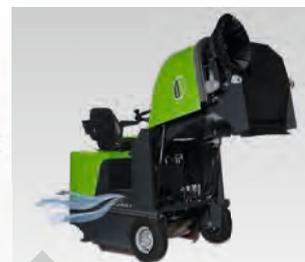
Hydraulische Entleerung des Kehrgutbehälters bis auf eine Höhe von bis zu 1,4 m.
