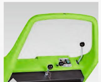
Bedienelemente: Steuerung zum Schließen/Öffnen der Absaugung, Rüttelfilter (mechanische Abreinigung), Anheben/Absenken der Seitenbürste
